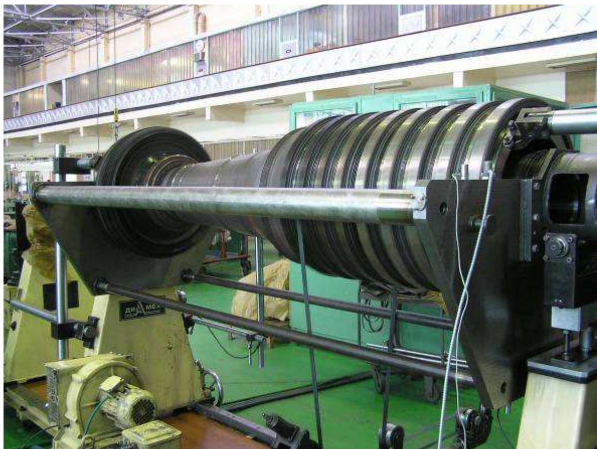
Рис. 1. Общий вид ротора на балансировочном стенде со стороны испытуемого подшипника. Видны акселерометры на люльке стенда
