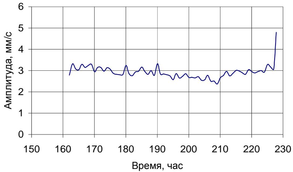
Рис. 5 Тренд составляющей ротора низкого давления по датчику  $\Gamma_T$  в течение последних 68 часов работы агрегата
