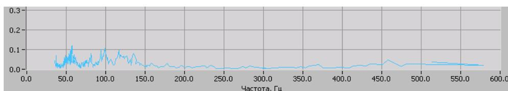
Рис. 13. Огибающая гармонических компонент с частотой BPF1
