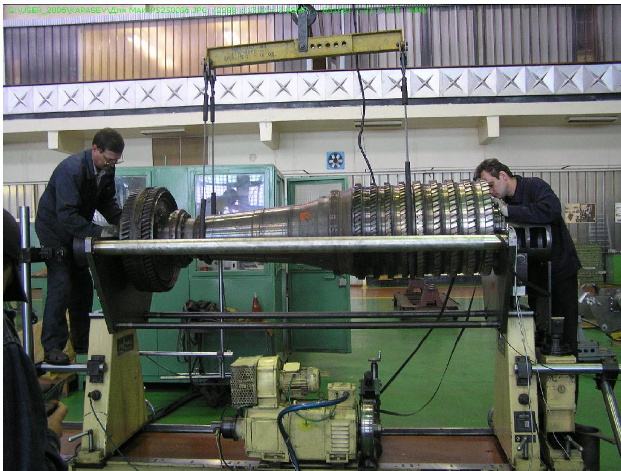
*Для оценки частот собственных колебаний пространственной системы балансировочного станда компании Диамех, установленного в ОАО "Газтурбосервис" в программной системе DYNAMICS R4 была создана модель станда. Стенд моделировался как пространственная система. Расчеты проводились в двух вариантах – без ротора и с ротором, установленным в люльках*
