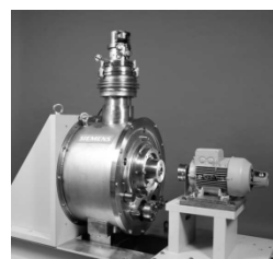
б) Синхронный генератор на сверхпроводящих магнитных подшипниках. Температура 28°К.
